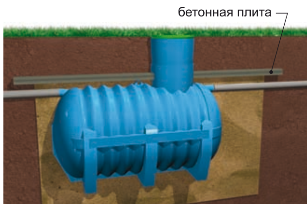
Установка септика на некотором углублении
