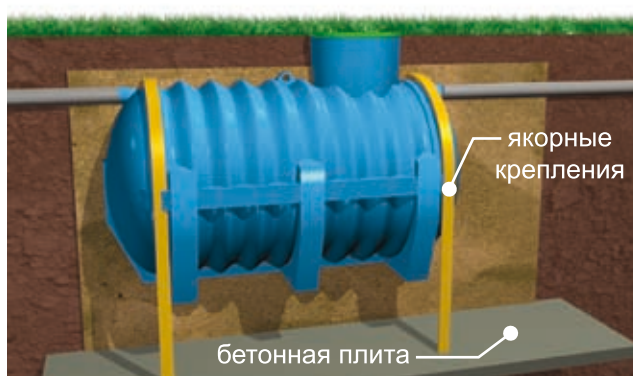
Установка септика при грунтовых водах
